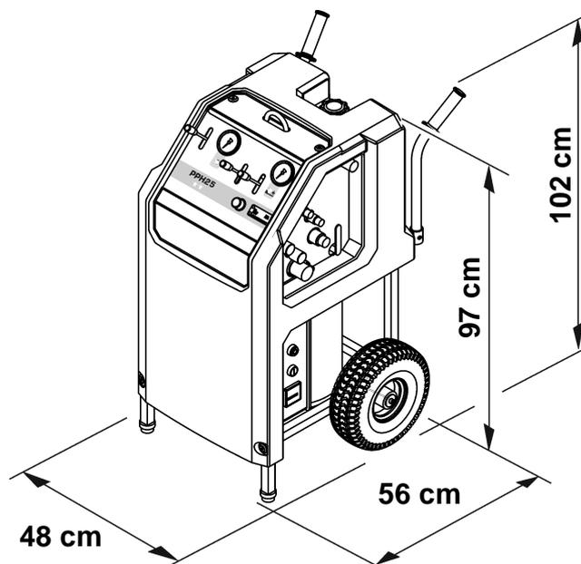
Fig. 1-3 Abmessungen
