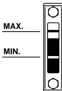
Fig. 4-7 Ölstandsanzeige
