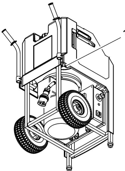
Fig. 6-1 Hydrauliköl wechseln
