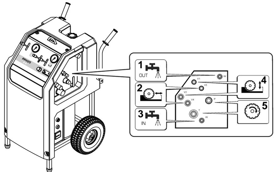
Fig. 5-1 Schlauchanschlüsse
