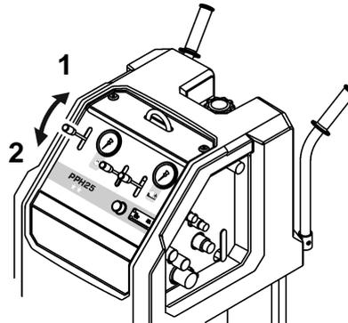
Fig. 5-4 Druckstufe wählen
